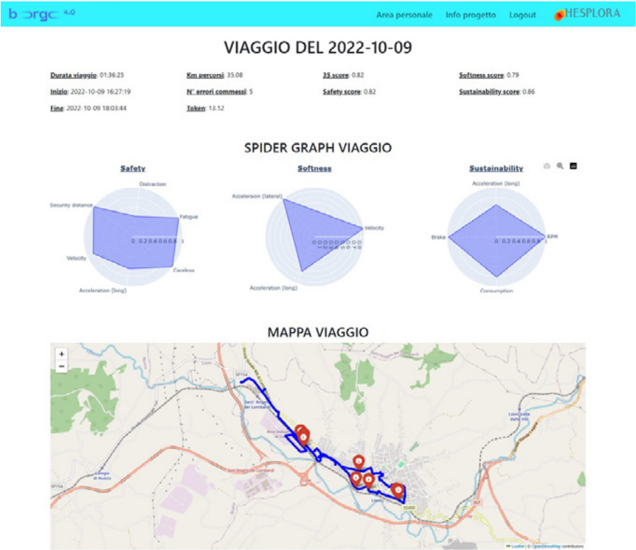
WebApp Hesplora per visualizzazione Profilo conducente e riepilogo dati viaggio con geolocalizzazione da satellite e dati da OBU
